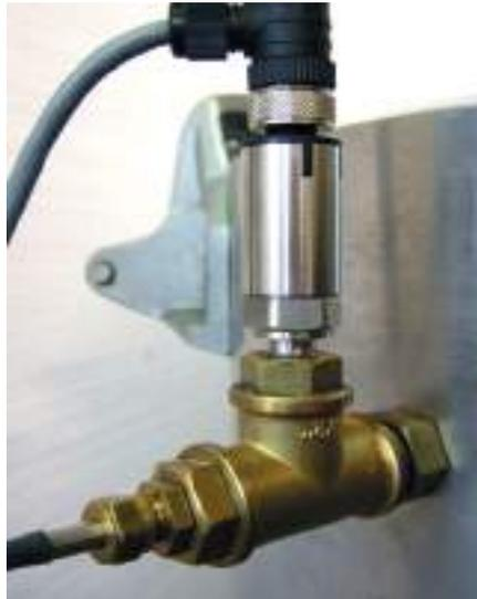
Les capteurs de pression et de température mesurent en permanence les conditions à l'intérieur de l'autoclave.
